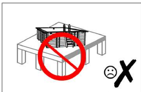
INSTALACIÓN EN UNA TERRAZA
