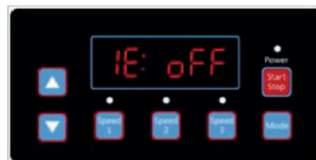
Diagrama 4.15, Anexo 1 Habilitar/Deshabilitar, Deshabilitar por defecto
