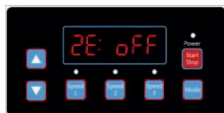
Diagrama 4.19, Anexo 2 Habilitar/Deshabilitar, Deshabilitado por defecto
